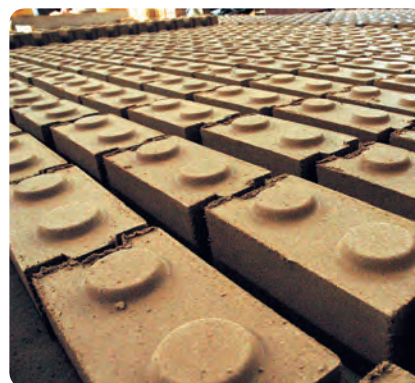
Fabricação de tijolo ecológico pela Universidade Federal da Paraíba em João Pessoa, PB.
